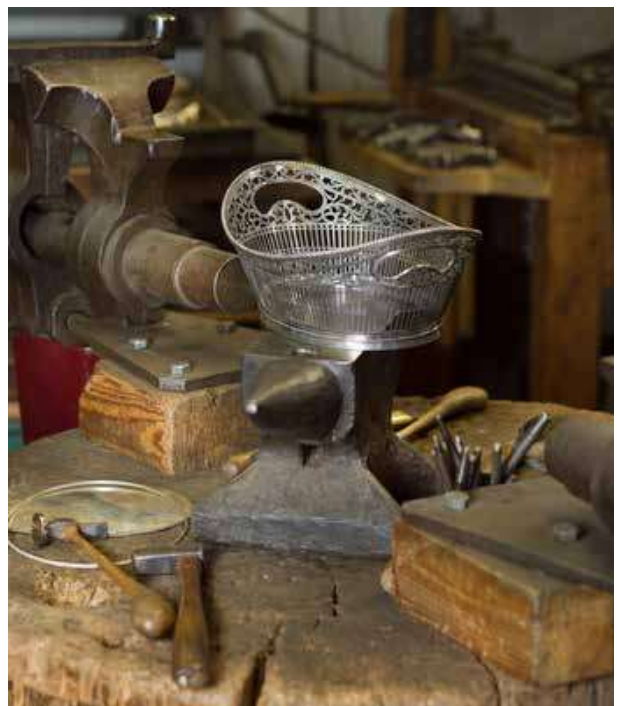
De broodmand heeft een losse bodem. Deze is er opnieuw ingezet en met graveersteken vastgezet. De mand wordt hier weer in model gebracht
